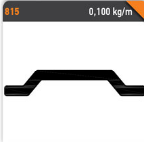
815 0,100 kg/m İspanyolet Profili Espagnolette Profile
