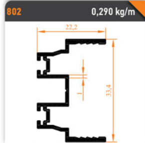
802 0,290 kg/m Isıcam Düz Kapak Menteşe Profil Double Glazing Straight Cap Hinge Profile
