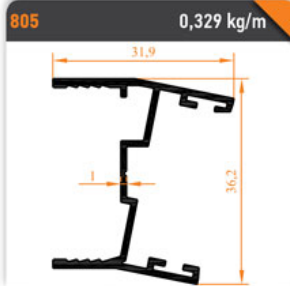
805 0,329 kg/m 11° Dönüş Profili 11° Return Profile
