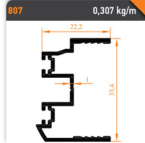
807 0,307 kg/m Açılı Dönüş Menteşe Profili Angle Return Hinge Profile
