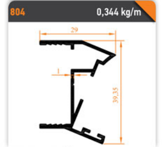
804 0,344 kg/m 22,5° Dönüş Profili 22,5° Return Profile
