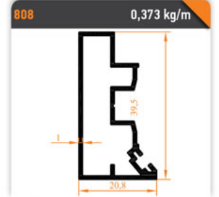
808 0,373 kg/m Yan Dikme Profili Side Pillar Profile
